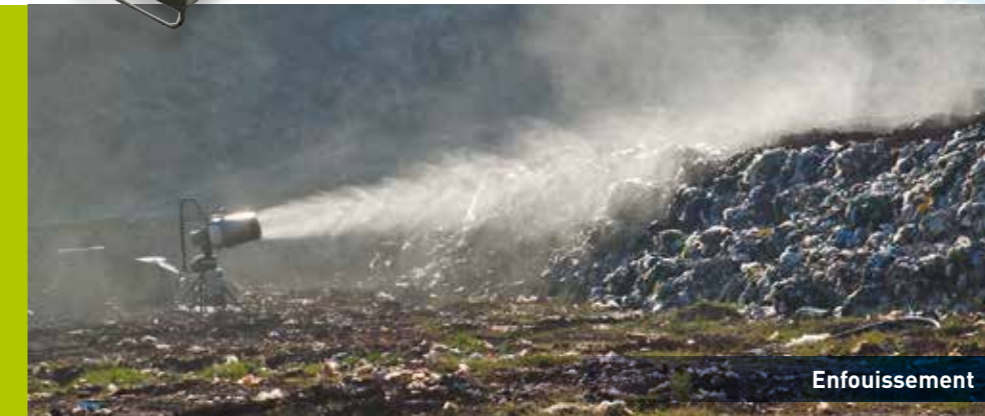
Un exemple de point de vaporisation : le TURBO-RAM® TRD 500.
