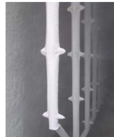
Electrodes et cibles réceptrices de poussières
